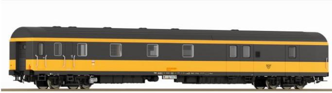
In mehreren Baulosen bauten die Simmering-Graz-Pauker Werke für die österreichische Postverwaltung vierachsige Bahnpostwagen. Konstruktionsmäßig entsprechen sie den Eurofima-Wagen. Der Wagenkasten und die Inneneinrichtung wurden für die Belange der
