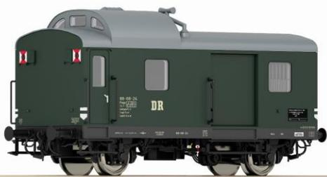
Der Waggonbau im ostdeutschen Bautzen stellte in den 1950er Jahren im Auftrag der DR einen kurzen Güterzug-Packwagen her. In zwei Bauserien wurden mehr als 200 Wagen beschafft. Als Besonderheit wiesen die Wagen eingebaute Schlusssignale auf, deren rot-weiße Flächen mit drehbaren Blenden abgedeckt werden konnten. Ab 1964 kamen die Wagen auch auf Nebenbahnen in Reisezügen zum Einsatz. Diese Wagen erhielten
