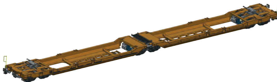
■ Chevalet de support en position haute pour les semi-remorques et en position basse pour le chargement des conteneurs
