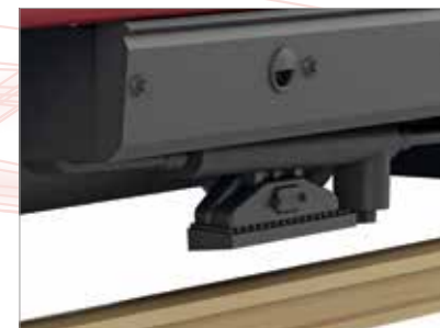
■ Magnete di protezione del treno
